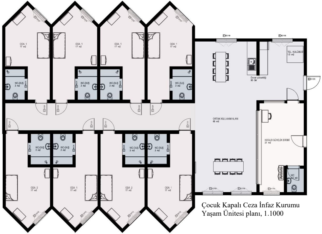
Şekil 4.7. Örnek bir yaşama ünitesi planı (yerinde gözlem sonucu hazırlanmıştır) (kaynak: yazar)
